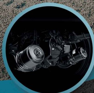
ระบบเบรกแบบสมล้อ พร้อมปรับตั้งเบรกอัตโนมัติ
